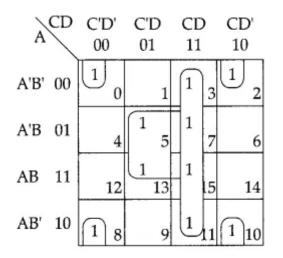
Quad 1 = m0 + m2 + m8 + m10 = B'D' Quad 2 = m3 + m7 + m15 + m11 = CD Quad 3 = m5 + m7 + m15 + m13 = BD Minimal SOP = B'D' + CD + BD
